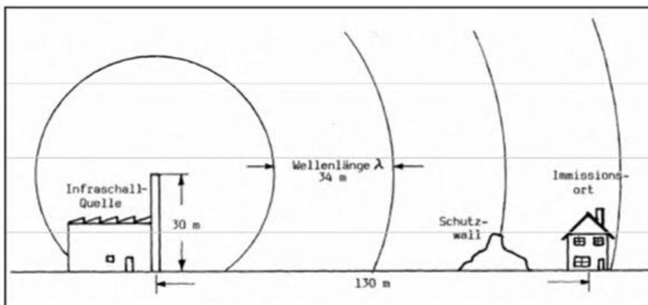
*Ausbreitung einer Infraschallwelle bei 10 Hz – Dimensionsvergleich -*
