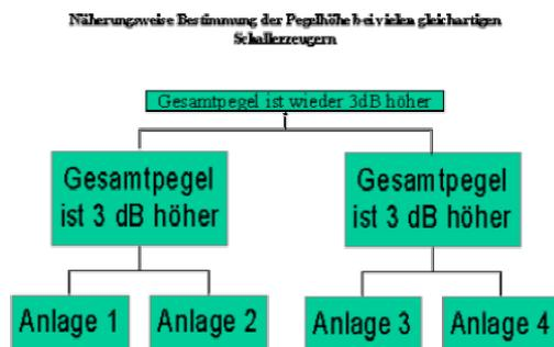
Hinzu kommt, dass durch mehrere Anlagen die Tendenz zur Turbulenzbildung durch gegenseitige Beeinflussung der Luftströmung an den Rotoren eher noch gesteigert wird. Darüber hinaus ist bei mehreren Anlagen besonders im langwelligen Bereich mit nicht vorhersagbaren Überlagerungseffekten auf dem Weg zwischen Schallquelle und Wirkort zu rechnen: es kann in der Laufzeit sowohl durch Addition der jeweiligen Amplituden sowohl zu Auslöschungen als auch zu maximalen Verstärkungen kommen.
